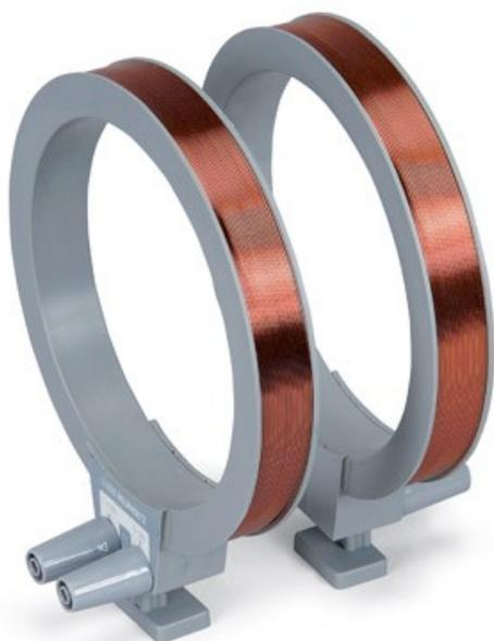
Le **Bobine di Helmholtz** sono un insieme di un grande numero di spire compatte di rame (circa 156). Le due bobine, di uguale diametro e con lo stesso numero di spire, disposte ad una distanza ben determinata e con asse coincidente, vengono collegate in serie a un generatore di corrente continua, in modo tale che il verso di percorrenza della corrente sia lo stesso.
